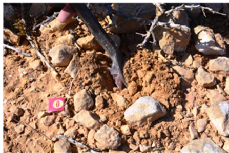
Figure 3b: Etapes 2.7. à 2.9 – Positionnement des sachets de thé dans le sol. Couches du sol: a) couche organique = humus (L =couche de litière de feuilles, F =couche de fragmentation-où la matière organique commence à se décomposer, H = couche d'humification ; b) horizons organo-minéraux (A = horizon riche en matière organique, B = horizon à faible teneur en matière organique ; c) roche mère.
