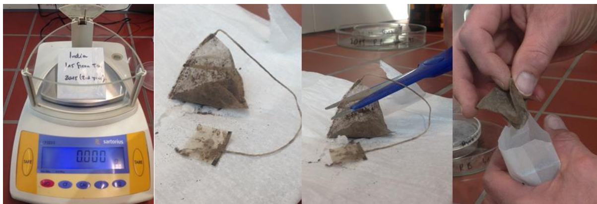
Рисунок 5: Шаги 4.1. – 4.6 – Обработка инкубированного в почве чая.
